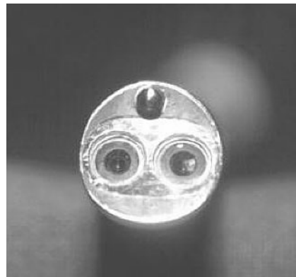
Abb. 17.4. Rechts: Fernes Ende eines 3D-Thoracoskops mit zwei Objektivlinsen und einem Spülkanal. Links: am Kopf des Operators angebrachtes ( head-mounted ) Flüssigkristalldisplay (LCD) für endoskopische Operationen (1). Das Mikrophon (2) kann dazu genutzt werden, jede Art von Bildern zu laden, z.B. Röntgen-, CT- oder MRT-Bilder
